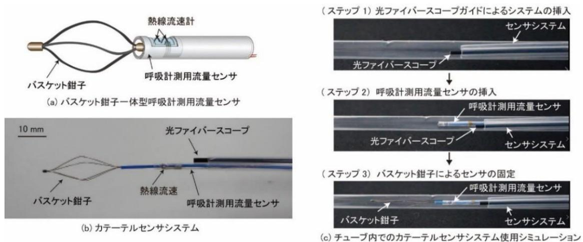
図 2. バスケット鉗子一体型呼吸計測用流量センサとそれを用いたカテーテルセンサ及び動作シミュレーション [6]
