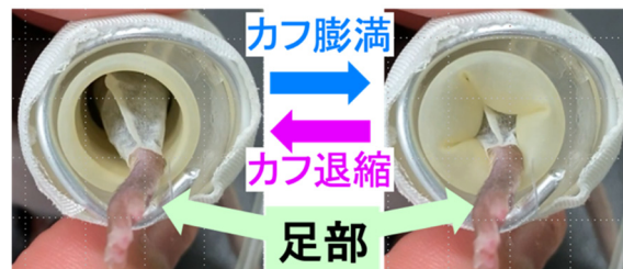
図6. 本研究課題用に新たに作製したマウス下腿筋周期的圧迫機
